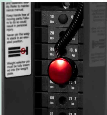
➤ Torre de placas con indicadores de peso en kg. y en lbs.
